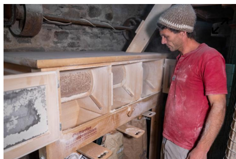
Olivier surveille son blutoir. Cet appareil composé de différents tamis permet de séparer la farine, la semoule (le germe) et le son (l'enveloppe). - Dominique Duchesnes.
